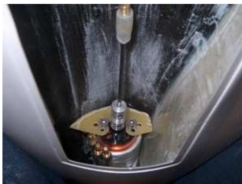
Ve svislé poloze lodě vytahujeme motor nahoru
