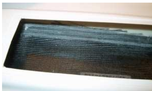
Lepené plochy přepážky i v trupu nahrubo přebrousíme
