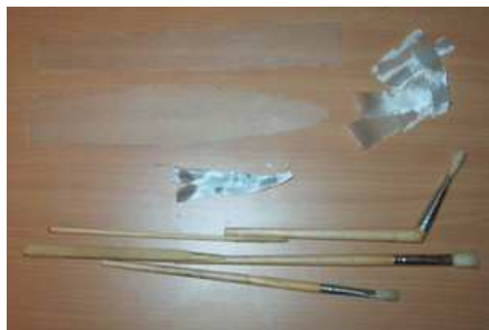
Nachytaný materiál a upravené štětce – stačí přiříznout a slepit vteřinákem
