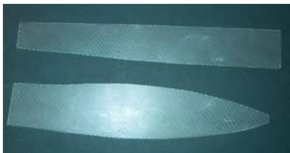
Nachystané poloviny přepážky zaplavovací komory
