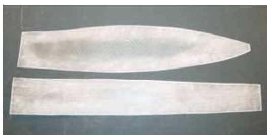
Lepené plochy přepážky i v trupu nahrubo přebrousíme
